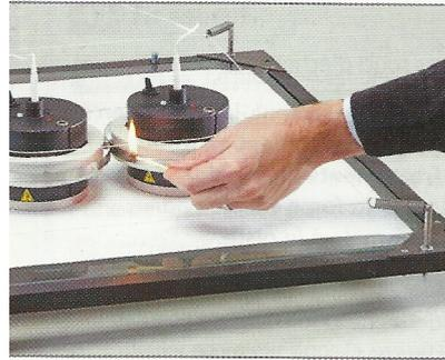
Deux mobiles autoporteurs munis de bagues sont attachés l'un contre l'autre. Les bagues sont comprimées comme sur le dispositif ci-contre. L'ensemble des mobiles A et B est immobile sur une table horizontale.
